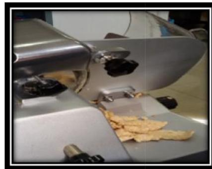
Gambar 9. Tempe yang Keluar dari Mesin Pengiris Tempe
